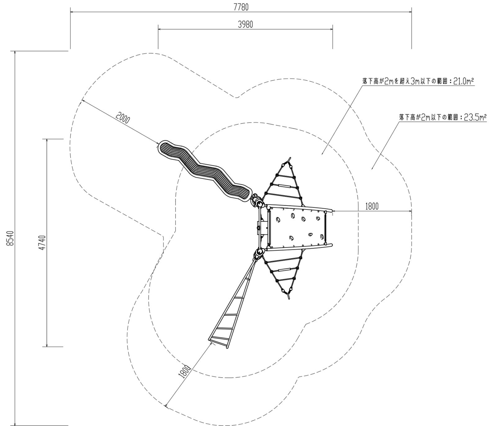
安全領域内は、落下高さに応じた衝撃吸収性能を有する設置面とする。
