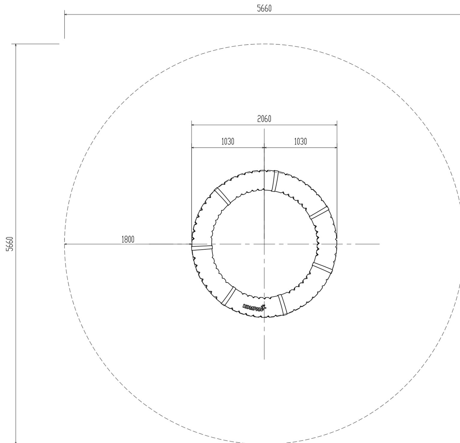
安全領域内は、落下高さに応じた衝撃吸収性能を有する設置面とする。
