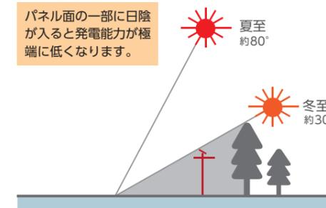
パネル面の一部に日陰が入ると発電能力が極端に低くなります。
